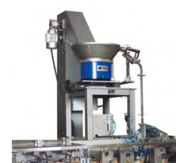
Valves insertion Inserción válvulas
